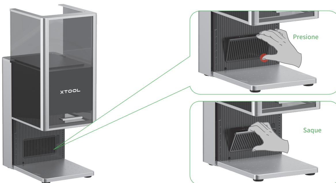
(2) Abra la cubierta y saque el módulo del ventilador.
