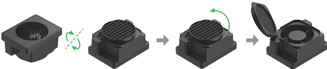
(4) Utilice un cepillo u otras herramientas para limpiar el módulo del ventilador y la rejilla magnética. Después de limpiarlos, vuelva a instalarlos en la unidad principal.
